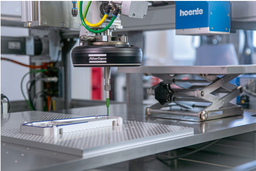
Hochgeschwindigkeits-Dosiersystem mit Einkomponentendosierer für Serien-Sealing-Applikationen.
