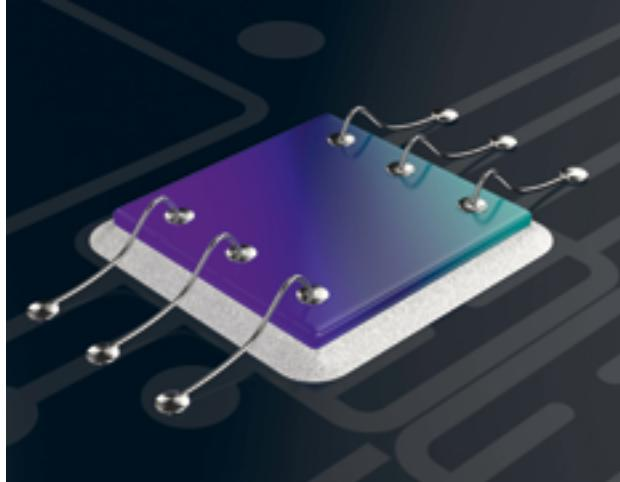
Aufgrund niedriger Aushärtetemperaturen sind elektrisch leitfähige Klebstoffe besonders für flexible und temperatursensible Substrate (Flex PCB) geeignet. Zudem weisen sie eine hohe chemische, mechanische und thermische Beständigkeit (z.B. gegen Reflowprozesse) auf.
