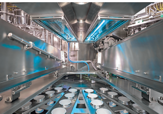
Hönle UVATEC mit UVC-Mitteldrucktechnologie zur Entkeimung von Lebensmittelverpackungen. Fotos: Dr. Hönle AG
